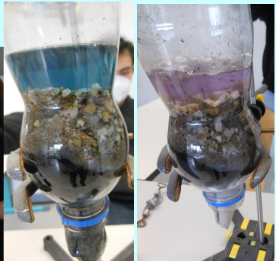
7., 8. „Kläranlage“ (Säulenform mit 2 verschied. Abwässern)
