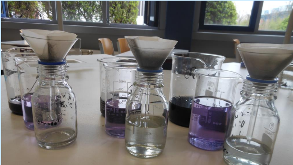
5. Trennung durch Adsorption (Aktiv-Kohle)
