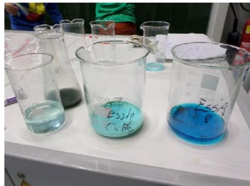
Herstellung eines Salzes aus Kupferdraht
